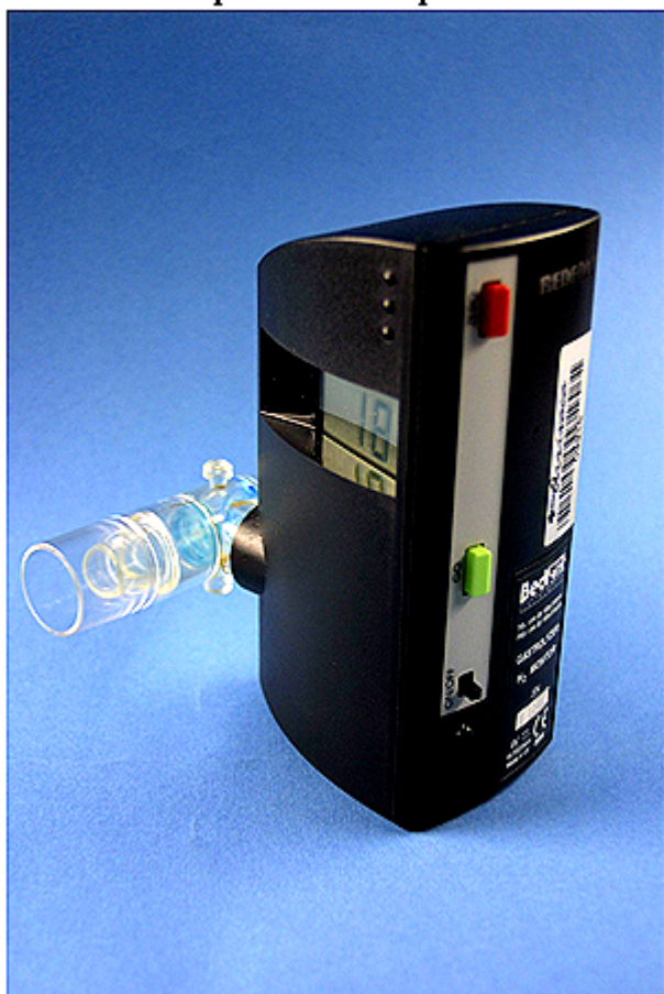
Foto.1. Monitor portátil de H2 espirado.
